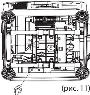
4. Поместите масляный поддон под двигателем. Наклоните генератор для полного слива отработанного масла
